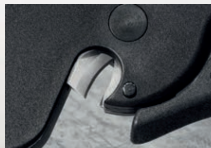
S nůžkami na kabely až do 10 mm 2 .
