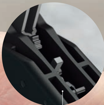
Aretační zařízení zajišťuje správný lisovací tlak.
